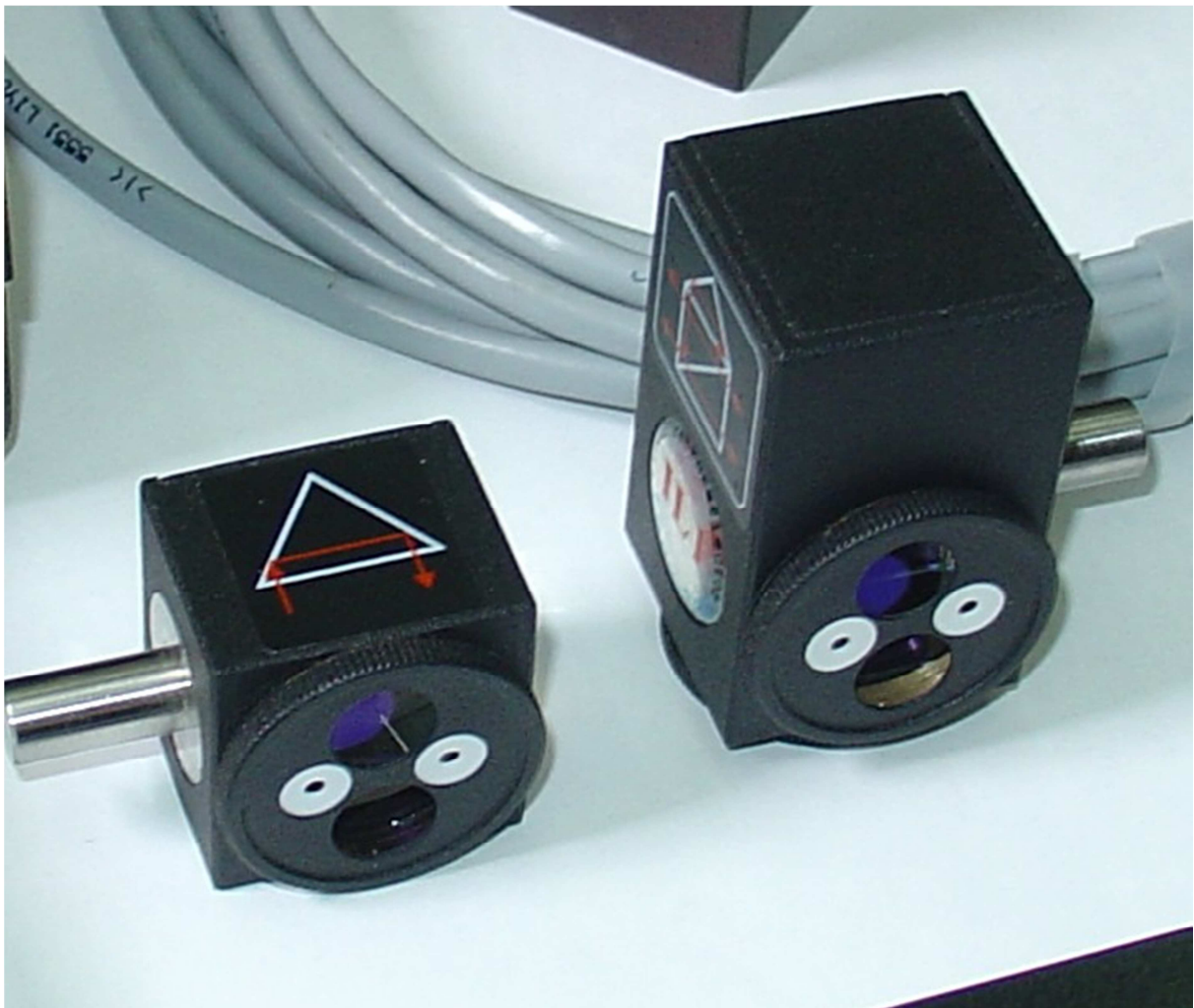
Рис. 4. Линейный рефлектор и интерферометр с перегородками установленными в так называемой точке работы
